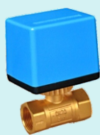
ДВУХХОДОВОЙ КЛАПАН ДУ20 с электроприводом 220В 0-3 ILH502-220-A (квс=7,5)
