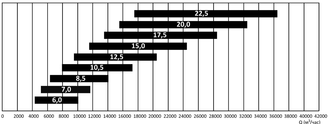
Интервалы производительности установок приточных типа УПКП при скоростях воздуха в свободном поперечном сечении установок от 2,0 м/с до 4,0 м/с.
