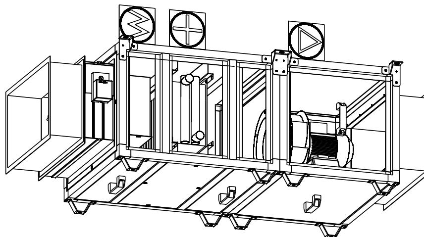
Установки подвесного исполнения снабжены металлическими кронштейнами с полимерным покрытием для крепления к несущим конструкциям и транспортировочными съемными ножками, устанавливаемыми на нижней поверхности установок.
