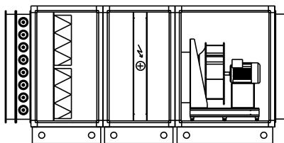
**Воздухонагреватель электрический** предназначен для нагрева поступающего в помещение воздуха. В качестве нагревательных элементов выступают трубчатые электронагреватели, преобразующие электрическую энергию в тепловую. Для защиты ТЭНов от перегрева воздухонагреватель оснащен встроенным терmostатом.
