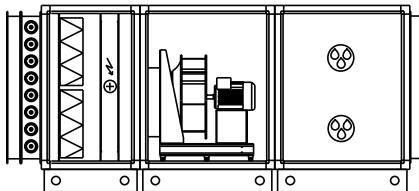
**Сотовый увлажнитель (PAD-Cooling)** - основной элемент системы это кассета, изготовленная из гофробумаги, которая монтируется в блок увлажнителя. Вода подается в верхнюю часть кассеты и стекает вниз по ее поверхности, в находящийся снизу водосборник. Сухой и теплый воздух, проходя через кассету, не только увлажняется, но и охлаждается.
