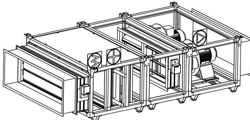
Установка вытяжная УПКП «Вариус» с секцией фильтрации и шумоглушения
