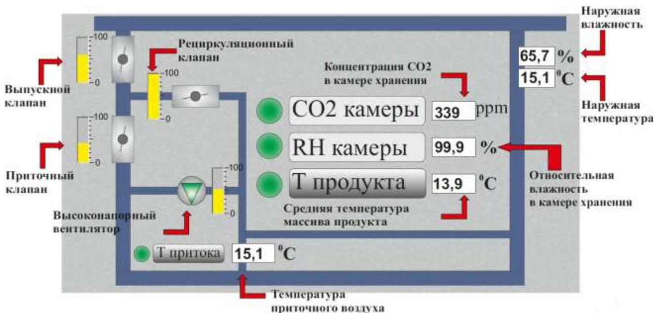
Программно-технологический комплекс KARDONI компании "Белтехком" - современная система контроля и управления технологическим процессом хранения в овощехранилище. KARDONI включает в себя пять режимов вентиляции: 'сушка', 'лечебие', 'охлаждение', 'хранение', 'прогрев', а также передовую динамическую функцию 'точная температура'.
