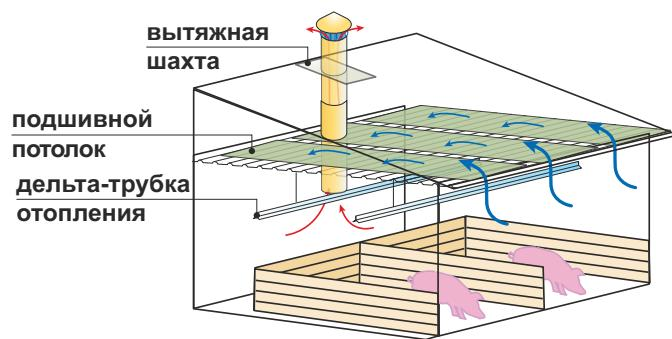
Схема вентиляции: приток через боковые клапаны, вытяжка - через крышиные вытяжные шахты
