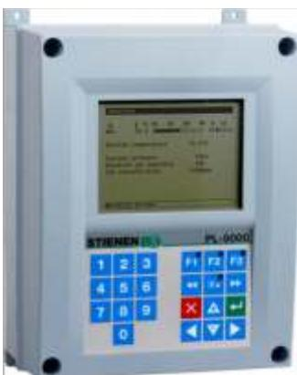
Этот контроллер разработан для обеспечения микроклимата в птичнике. Он имеет очень гибкую конфигурацию, позволяющую настроить систему автоматического управления для работы с любым набором вентиляционного оборудования (вентиляционные шахты, приточные форточки, торцевые вентиляторы, система водяного охлаждения и др.). На жидкокристаллическом дисплее в режиме реального времени отображаются все необходимые параметры: показания датчиков температуры и влажности, производительность вентиляторов и т.д.
