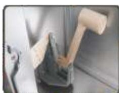
**Жалюзи** вентилятора открываются автоматически при пуске вентилятора, благодаря наличию специального молоточка и антикрыла. Данная конструкция позволяет эффективно управлять открытием жалюзи, уменьшает потери по воздуху при работающем вентиляторе и по теплу при отключенном.
