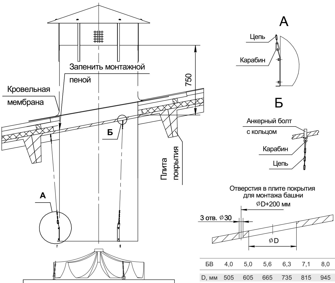
Башни вентиляционные устанавливаются в отверстия определенного диаметра на крыше здания и подвешиваются к потолку с помощью карабинов и цепей. Затем, подбирая звенья цепей, осуществляется выравнивание башни строго в вертикальном положении.
