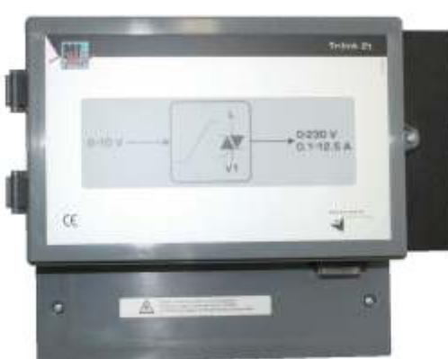
Симистор Trilink-2T применяется для регулировки скорости вращения однофазного вентилятора. Можно отметить полезную функцию: при старте симистор запускает вентилятор на полную мощность на несколько секунд и только после этого выводит его на заданную частоту вращения, что предотвращает повреждение вентилятора при его примерзании в зимний период при длительном простое.
