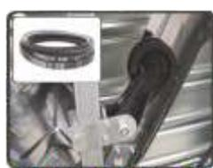
**Японские ремни** применяемые на вентиляторах очень надежны и долговечны, а специальный механизм всегда обеспечивает требуемый уровень натяжения ремня. Даже при долговременной работе без обслуживания производительность вентилятора не изменяется.
