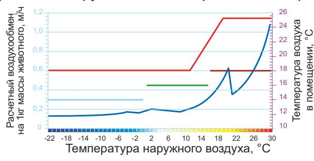
Расчетная потребность в воздухообмене в секции супоросных свиноматок в зависимости от наружной температуры воздуха в условиях теплой климатической зоны
