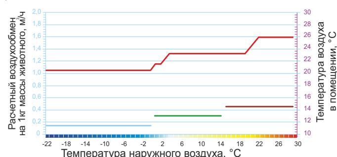
Расчетная потребность в воздухообмене в секции доращивания поросят отъемышей в зависимости от наружной температуры воздуха в условиях теплой климатической зоны
