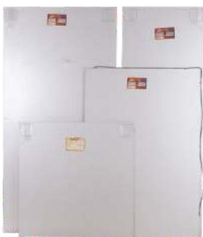
Нагревательные панели предназначены для локального обогрева поросят в секциях опороса и добрачивания. Они представляют собой надежные и прочные изделия из сплава Galvalume и теплозащитного экрана. Внутри панели расположен нагревательный кабель, изолированный силиконовой оболочкой. Слой сплава обеспечивает равномерный и быстрый прогрев поверхности панели, заменитель полиуретана выполняет функцию теплоизоляции.
