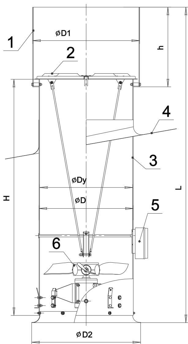
Башня вентиляционная вытяжная **БВВ** состоит из дефлектора (1), корпуса цилиндрического (3), фартука (4). В корпусе башни установлен клапан (2) с электроприводом (5) и осевой вентилятор (6). Корпус башни (3) и дефлектор (1) выполнены из полипропилена. В качестве привода вентилятора используется асинхронный трехфазный (однофазный) двигатель типа АИР либо трехфазное (однофазное) мотор-колесо . Степень защиты IP55.
