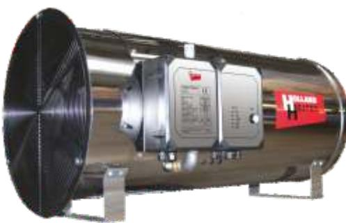
Воздухонагреватели серии ВГ изготовлены из нержавеющей стали высокого качества, не восприимчивой к воздействию влаги, пыли, грязи и аммиака, специально предназначеннной для помещений, где содержаться животные. Части горелки и камеры сгорания выполнены из жаростойкой нержавеющей стали.
