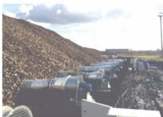
В районах с устойчивыми зимними холодами рекомендуется проводить замораживание свеклы естественным холодом. При этом в кагаты в течении нескольких суток вентилятором подается наружный морозный воздух. Замораживание свеклы осуществляется до тех пор пока ее температура не достигнет от -12 до -15 °C, при которой свекловичные корни как бы закостеневают. Во избежании оттаивания кагаты с замороженной свеклой необходимо укрывать. Замороженная свекла почти без потерь храниться до конца мая.
