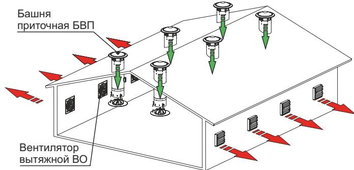
Приток через вентиляционные шахты - вытяжка через оконные осевые вентиляторы
