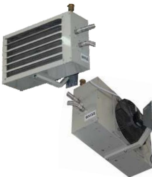
Тепловентилятор ТВ разработан для воздушного отопления помещений посредством нагрева внутреннего воздуха помещения с использованием теплоносителя. Для соединения с внешней системой используются стальные патрубки с резьбой на конце. Рабочее давление теплоносителя в теплообменниках ТВ должно быть не более 1,6 МПа, а температура теплоносителя не должна превышать 150 °С.
