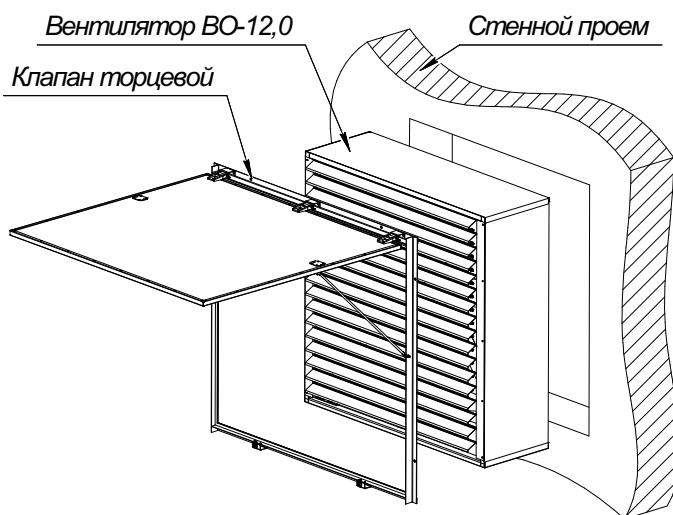
При проектировании всех современных птичников предусматривается летний режим туннельной вентиляции. Как правило, этот режим работает только в жаркое время года, при высоких внешних температурах. В зимний и переходный период через вентиляторы и приточные жалюзи в помещение может попасть холодный воздух, что может негативно повлиять на здоровье птицы и увеличивает затраты на обогрев помещения.
