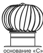
Турбины работают без потребления электроэнергии, используя природный источник энергии - ветер. Благодаря вращению турбина создает разрежение и вытягивает теплый и влажный воздух из внутреннего пространства дома и кровли, продлевая срок их службы и обеспечивая эффективную защиту от образования конденсата.
