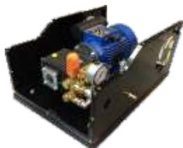
Насос высокого давления является лучшим решением для небольших и средних систем туманообразования с расходом воды от 0,3 до 25 л в минуту, приводимых в действие однофазными моторами. Плунжерный насос для работы систем увлажнения-охлаждения воздуха открытых пространств (летние веранды, кафе, парки и т.д.) где управление осуществляется через контроллер с минимальным набором функций, чаще всего это обычный таймер. Для защиты от перегрева обязательна установка автоматов защиты двигателей М611.
