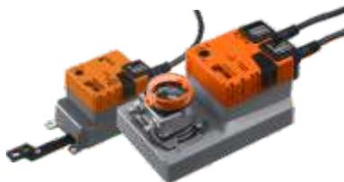
Электроприводы предназначены для управления воздушными клапанами. Все электроприводы содержат электродвигатель и зубчатый редуктор самого высокого качества и имеют сложную электронную систему управления. Привод оснащен механическими упорами, при достижении которых он автоматически останавливается, соответственно, не требуются дополнительные концевые выключатели.
